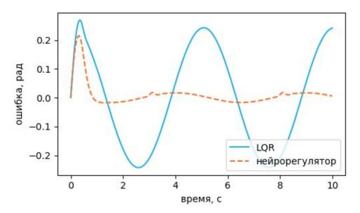
Рисунок 4.19 - Ошибки слежения систем управления гидроприводом с линейно-квадратичным регулятором и нейрорегулятором за гармоническим сигналом (частота 1.27 рад/с, амплитуда 1 рад)
