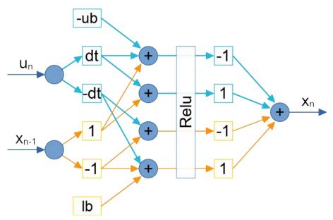
Рисунок 2.9 - Схема нейронной сети, точно повторяющей динамику дискретного интегратора с ограничителем (dt – время дискретизации, ub и lb – значение верхнего и нижнего ограничения соответственно)
