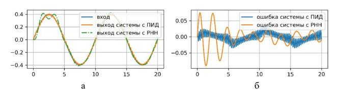
Рисунок 2.25 - Реакция объекта и РНН на гармонический сигнал (sin) амплитудой 0,4 и частотой 0,1 Гц: а – реакция систем, б – ошибка слежения
