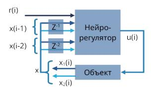
Рисунок 1.10 - Схема обучения нейрорегулятора в методе инверсного нейроуправления
