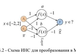
Рисунок 3.2 - Схема ИНС для преобразования в МІР задачу
