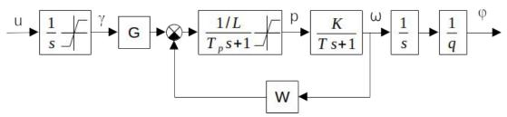
Рисунок 4.11 - Структурная схема базовой системы гидропривода
