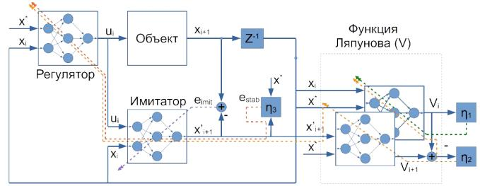
Рисунок 4.6 - Схема синтеза нейросетевого регулятора по разработанной методике
