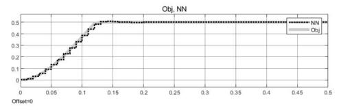
Рисунок 2.19 - Реакция объекта и нейроимитатора на ступенчатый сигнал амплитудой 2 (ограничения достигаются)
