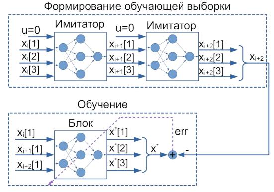
Рисунок 4.15 - Схема обучения нейронной сети преобразованию сигнала управления системой в заданный вектор состояния для объекта 3 порядка
