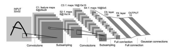
Рисунок 1.3 - Схема сверточной нейронной сети LeNet-5 [29]
