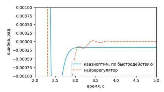
Рисунок 4.30 - Установившаяся ошибка слежения систем управления гидроприводом с квазиоптимальным по быстродействию и нейросетевым регуляторами на ступенчатый сигнал амплитудой π рад. (масштабированный угол)
