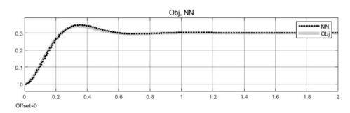
Рисунок 2.18 - Реакция объекта и нейроимитатора на ступенчатый сигнал амплитудой 0.3 (ограничения не достигаются)
