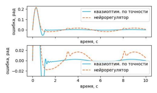
Рисунок 4.23 - Ошибка слежения систем управления гидроприводом с квазиоптимальным по точности и нейросетевым регуляторами за гармоническим сигналом (частота 1.27 рад/с, амплитуда 1 рад)
