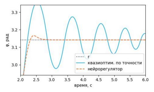
Рисунок 4.25 - Реакция систем управления гидроприводом с квазиоптимальным по точности и нейросетевым регуляторами на ступенчатый сигнал амплитудой  $\pi$  рад (масштабированный угол)
