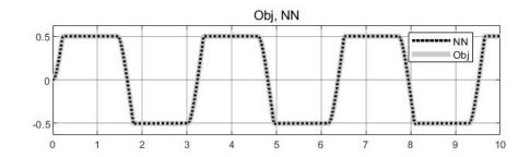
Рисунок 2.13 - Реакция объекта и нейроимитатора на гармонический сигнал, при котором достигаются ограничения
