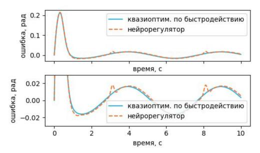
Рисунок 4.27 - Ошибка слежения систем управления гидроприводом с квазиоптимальным по быстродействию и нейросетевым регуляторами за гармоническим сигналом (частота 1.27 рад/с, амплитуда 1 рад)
