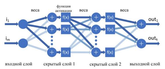
Рисунок 1.2 - Структура многослойной нейронной сети прямого распространения
