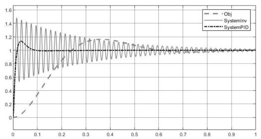
Рисунок 2.4 - Реакция на ступенчатый сигнал: объекта управления, системы с регулятором по уравнению (2.9) и системы с ПИД регулятором
