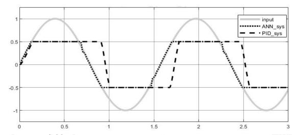
Рисунок 2.22 - Реакция системы с нейросетевым регулятором и ПИД регулятором для звена с ограничителем типа насыщение на гармонический сигнал амплитудой 1, при которых ограничения достигаются
