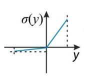
Рисунок 3.1 - График функции leakyReLU
