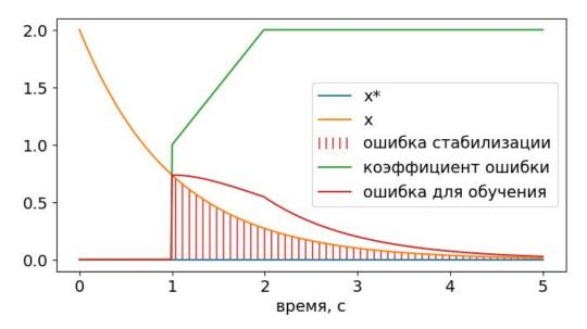
Рисунок 4.5 - График ошибки для обучения нейрорегулятора на выполнение требований по времени регулирования (на графике 1 сек.)
