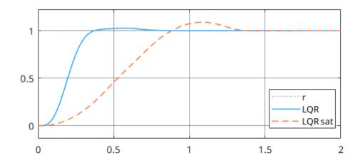
Рисунок 4.17 - Переходный процесс замкнутой системы с гидроприводом с LQR без учета ограничителей и с их учетом
