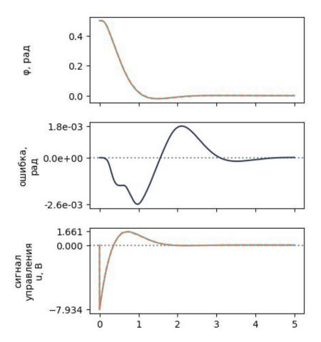
Рисунок 4.14 - Переходный процесс из начальных условий в нулевое положение системы управления с линейно квадратичным и нейросетевым регулятором
