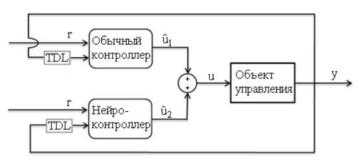
Рисунок 1.13 - Схема параллельного гибридного нейроуправления [23]
