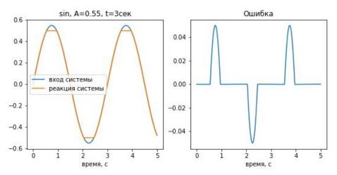
Рисунок 2.29 - Результат моделирования системы с нейрорегулятором (sin, A=0.55, T=3c)
