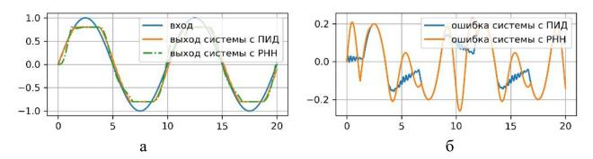
Рисунок 2.26 - Реакция объекта и РНН на гармонический сигнал (sin) амплитудой 1 и частотой 0,1 Гц: а – реакция систем, б – ошибка слежения
