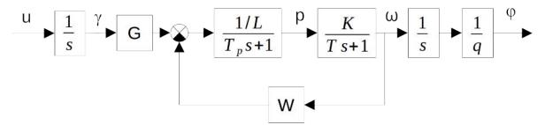
Рисунок 4.13 - Схема линейной базовой модели гидропривода
