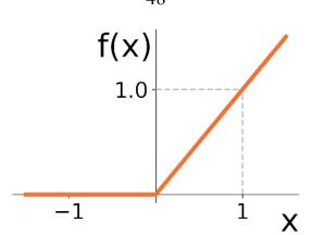
Рисунок 2.8 - График функции ReLU
