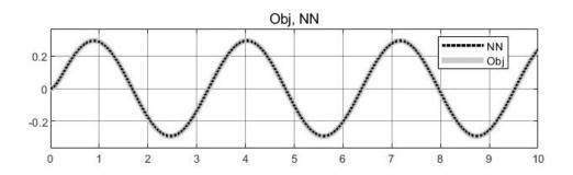
Рисунок 2.12 - Реакция объекта и нейроимитатора на гармонический сигнал, при котором не достигаются ограничения
