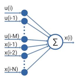
Рисунок 2.1 - Схема искусственной нейронной сети с одним нейроном
