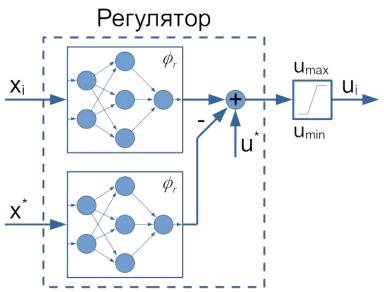
Рисунок 3.5 - Схема нейрорегулятора по методу синтеза нейросетевой системы управления с теоретической гарантией устойчивости. На схеме одна и та же нейронная сеть используется дважды для расчета сигнала управления объектом
