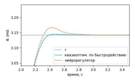
Рисунок 4.29 - Реакция систем управления гидроприводом с квазиоптимальным по быстродействию и нейросетевым регуляторами на ступенчатый сигнал амплитудой π рад (масштабированный угол)
