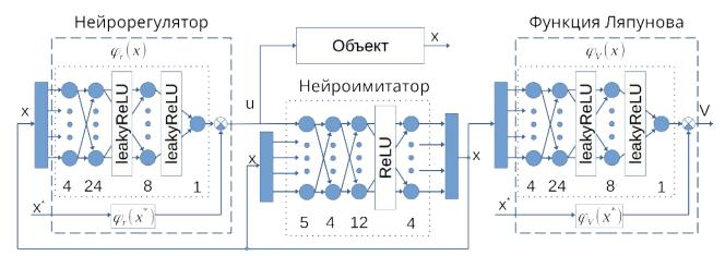
Рисунок 4.12 - Структура нейронных сетей в нейросетевой системе, используемой при обучении нейрорегулятора
