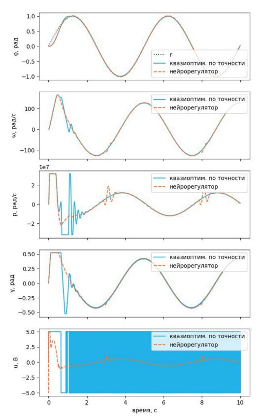
Рисунок 4.22 - Реакция систем управления гидроприводом с квазиоптимальным по точности и нейросетевым регуляторами на гармонический сигнал (частота 1.27 рад/с, амплитуда 1 рад)
