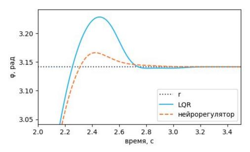
Рисунок 4.21 - Реакции систем управления гидроприводом с линейноквадратичным и нейросетевым регулятором на ступенчатый сигнал амплитудой π рад (масштабированный угол)
