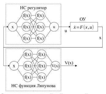
Рисунок 3.4 - Структура замкнутой нейросетевой системы управления для метода синтеза устойчивой замкнутой системы управления с нейрорегулятором
