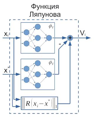
Рисунок 3.7 - Схема нейросетевой функции Ляпунова
