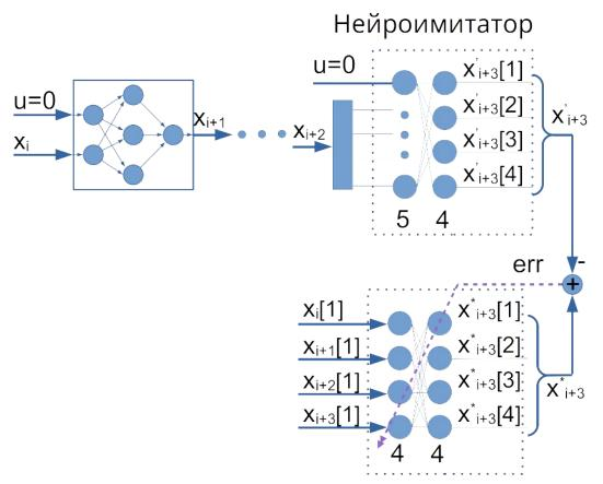
Рисунок 4.16 - Схема обучения нейронной сети, преобразующей входное воздействие в заданный вектор состояния, для гидропривода, обучаемого на линейной части нейроимитатора
