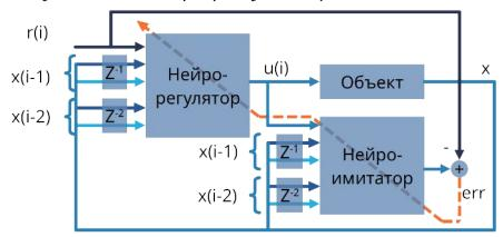
Рисунок 1.11 - Схема обучения в методе обратного пропуска ошибки через нейроимитатор
