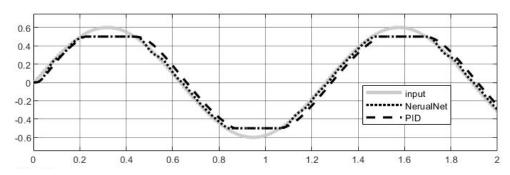
Рисунок 2.24 - Реакция системы с нейросетевым регулятором и ПИД регулятором для звена с ограничителем типа жесткий механический упор на гармонический сигнал амплитудой 0.6, при которых ограничения достигаются
