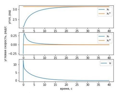
Рисунок 3.15 - График переходного процессы системы с перевернутым маятником, переходящий из начальной точки фазового пространства в точку равновесия без требований к времени регулирования
