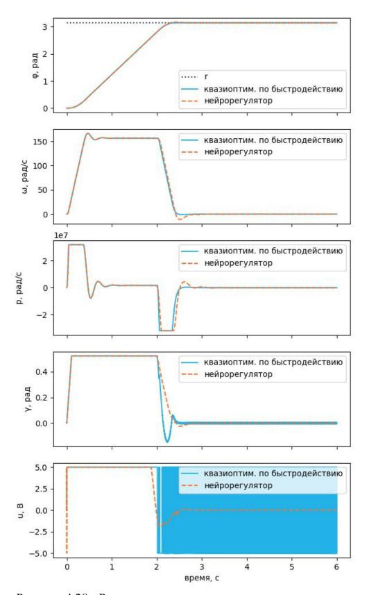
Рисунок 4.28 - Реакция систем управления гидроприводом с квазиоптимальным по быстродействию и нейросетевым регуляторами на ступенчатый сигнал амплитудой  $\pi$  рад
