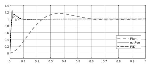
Рисунок 2.5 - Реакция на ступенчатый сигнал: объекта управления, системы с нейрорегулятором, обученным по уравнению (2.9) и системы с ПИД регулятором
