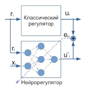
Рисунок 4.2 - Схема предварительного обучения нейрорегулятора на аппроксимацию классического регулятора
