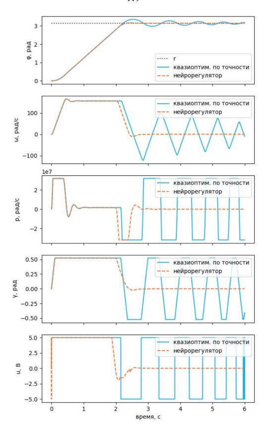
Рисунок 4.24 - Реакция систем управления гидроприводом с квазиоптимальным по точности и нейросетевым регуляторами на ступенчатый сигнал амплитудой π рад
