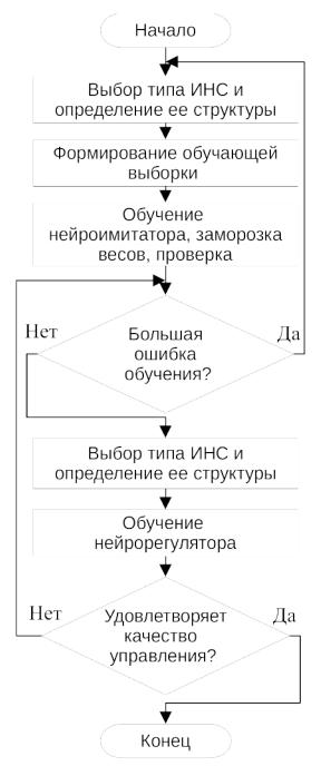
Рисунок 2.27 - Блок схема метода синтеза нейросетевого регулятора на основе схемы обучения обратного пропуска ошибки через нейроимитатор
