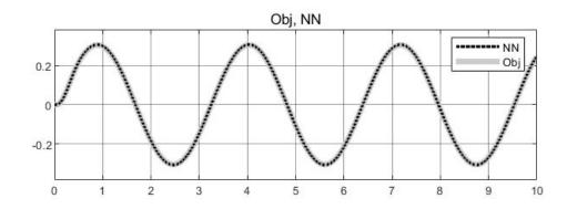
Рисунок 2.16 - Реакция объекта и нейроимитатора на гармонический сигнал, при котором ограничения не достигаются
