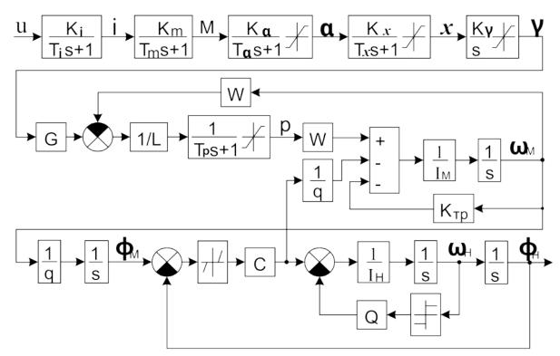
Рисунок 4.10 - Структурная схема гидропривода [76]
