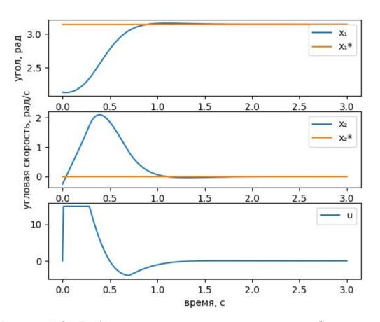
Рисунок 4.8 - График переходного процесса системы стабилизации перевернутого маятника с оптимизацией времени регулирования
