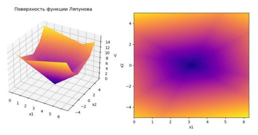
Рисунок 4.7 - Поверхность функции Ляпунова для замкнутой системы стабилизации перевернутым маятником
