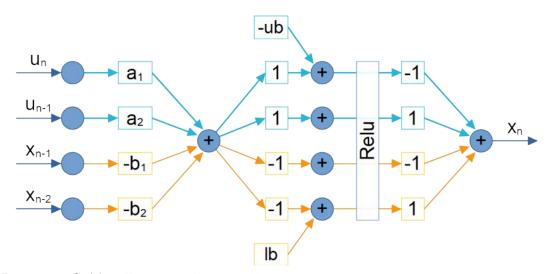
Рисунок 2.11 - Схема нейронной сети, точно повторяющей динамику дискретного звена с ограничителем типа жесткий механический упор. (коэффициенты  $a_1$ ,  $a_2$ ,  $b_1$ ,  $b_2$  — значения коэффициентов из разностного уравнения,  $u_b$  и  $l_b$  — значение верхнего и нижнего ограничения соответственно)
