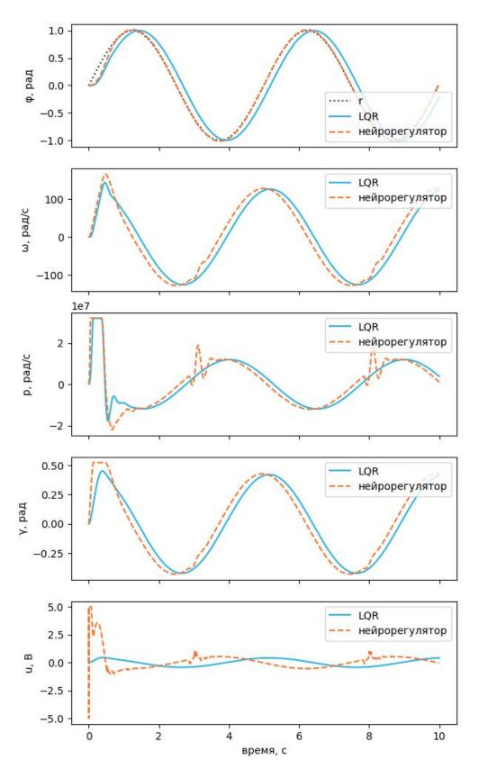
Рисунок 4.18 - Реакция систем управления гидроприводом с линейноквадратичным и нейросетевым регуляторами на гармонический сигнал (частота 1.27 рад/с, амплитуда 1 рад)
