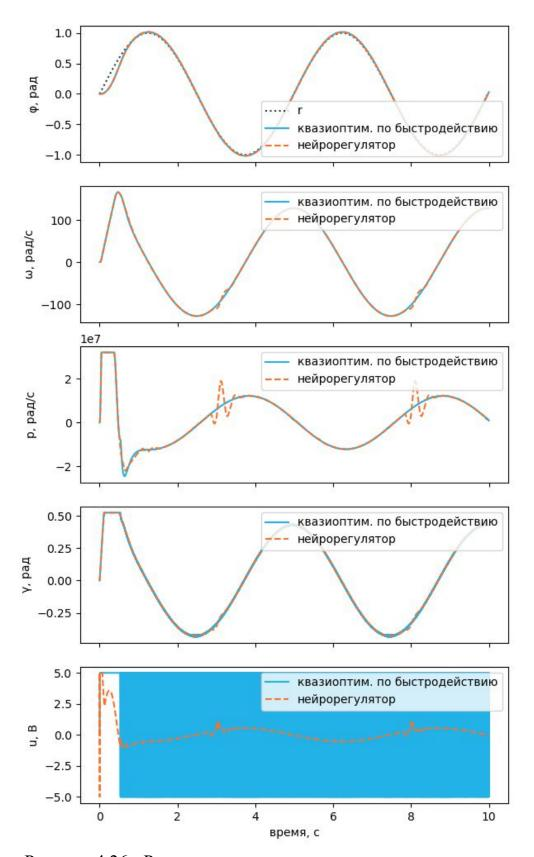
Рисунок 4.26 - Реакция систем управления гидроприводом с квазиоптимальным по быстродействию и нейросетевым регуляторами на гармонический сигнал (частота 1.27 рад/с, амплитуда 1 рад)
