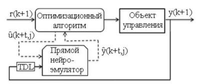
Рисунок 1.12 - Схема прогнозирующего модельного нейроуправления [23]
