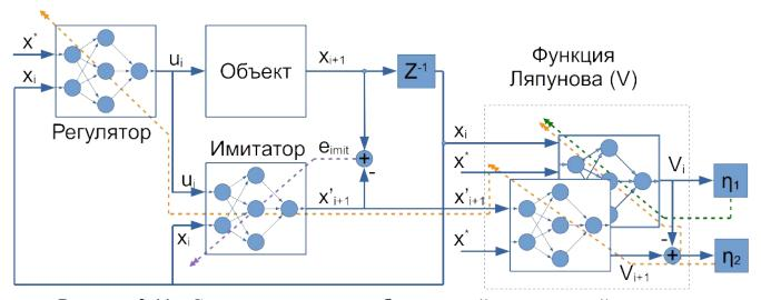
Рисунок 3.11 - Сокращенная схема обучения нейронных сетей по методу синтеза устойчивой замкнутой системы управления в заданной области фазового пространства
