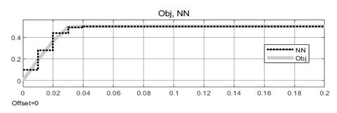
Рисунок 2.15 - Реакция объекта и нейроимитатора на ступенчатый сигнал амплитудой 2 (ограничения достигаются)
