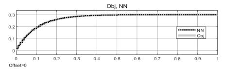
Рисунок 2.14 - Реакция объекта и нейроимитатора на ступенчатый сигнал амплитудой 0.3 (ограничения не достигаются)
