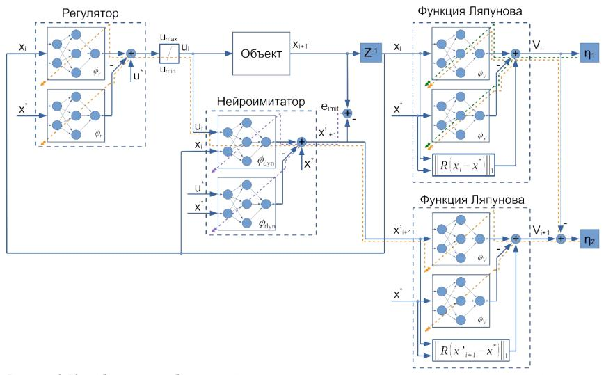
Рисунок 3.10 - Общая схема обучения нейронных сетей по методу синтеза устойчивой замкнутой системы управления в заданной локальной области фазового пространства
