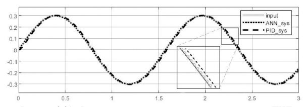
Рисунок 2.21 - Реакция систем с нейросетевым регулятором и ПИД регулятором для звена с ограничителем типа насыщение на
