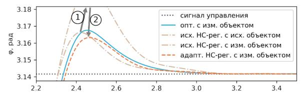
Рисунок 4.31 - Реакция системы с измененным ОУ на ступенчатый сигнал: 1 - ухудшение качества переходного процесса при увеличении момента нагрузки ОУ, 2 - нейрорегулятор адаптировался под измененный ОУ
