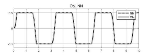
Рисунок 2.17 - Реакция объекта и нейроимитатора на гармонический сигнал, при котором ограничения достигаются
