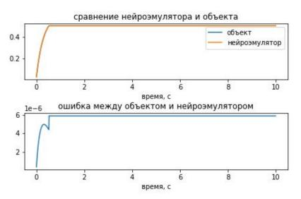
Рисунок 2.28 - Сравнение выхода объекта и обученного нейроимитатора
