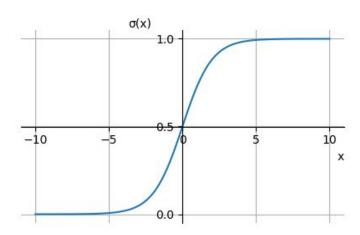
Рисунок 1.5 - График логистической функции (сигмоида)
