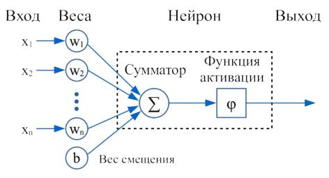
Рисунок 1.1 - Схема нейрона
