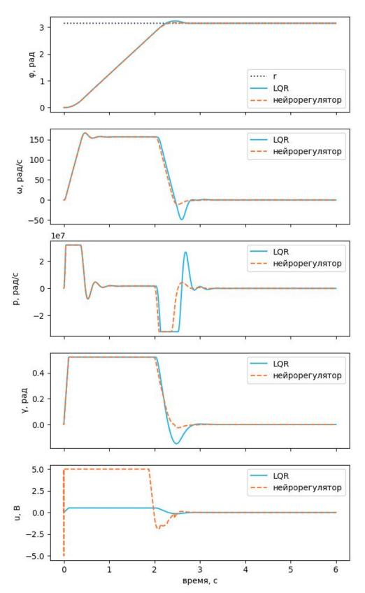
Рисунок 4.20 - Реакция систем управления гидроприводом с линейноквадратичным и нейросетевым регулятором на ступенчатый сигнал амплитудой  $\pi$  рад
