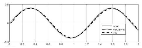
Рисунок 2.23 - Реакция системы с нейросетевым регулятором и ПИД регулятором для звена с ограничителем типа жесткий механический упор на гармонический сигнал амплитудой 0.4, при котором ограничения не достигаются
