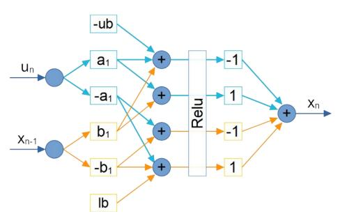
Рисунок 2.10 - Схема нейронной сети, точно повторяющей динамику дискретного звена с ограничителем типа насыщение. (коэффициенты  $a_1$  и  $b_1$  – значения коэффициентов из разностного уравнения, ub и lb – значение верхнего и нижнего ограничения соответственно)
