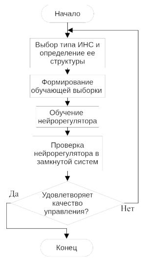
Рисунок 2.20 - Метод синтеза нейрорегулятора на основе схемы обучения инверсного нейроуправления для объектов с ограничителями
