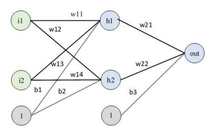
Рисунок 1.8 - Схема нейронной сети для примера расчета методом обратного распространения ошибки
