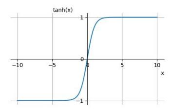
Рисунок 1.6 - График гиперболического тангенса
